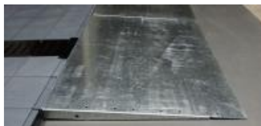
W 型斜坡系統有 1:12 與 1:20 兩種基本坡度比 40mm 高: CA425W-480 (480mm 長) (1:12) CA425W-800 (800mm 長) (1:20) 60mm 高: CA625W-720 (720mm 長) (1:12) CA625W-1200 (1200mm 長) (1:20) 70mm 高: CA725W-840 (840mm 長) (1:12) CA725W-1400 (1400mm 長) (1:20)
